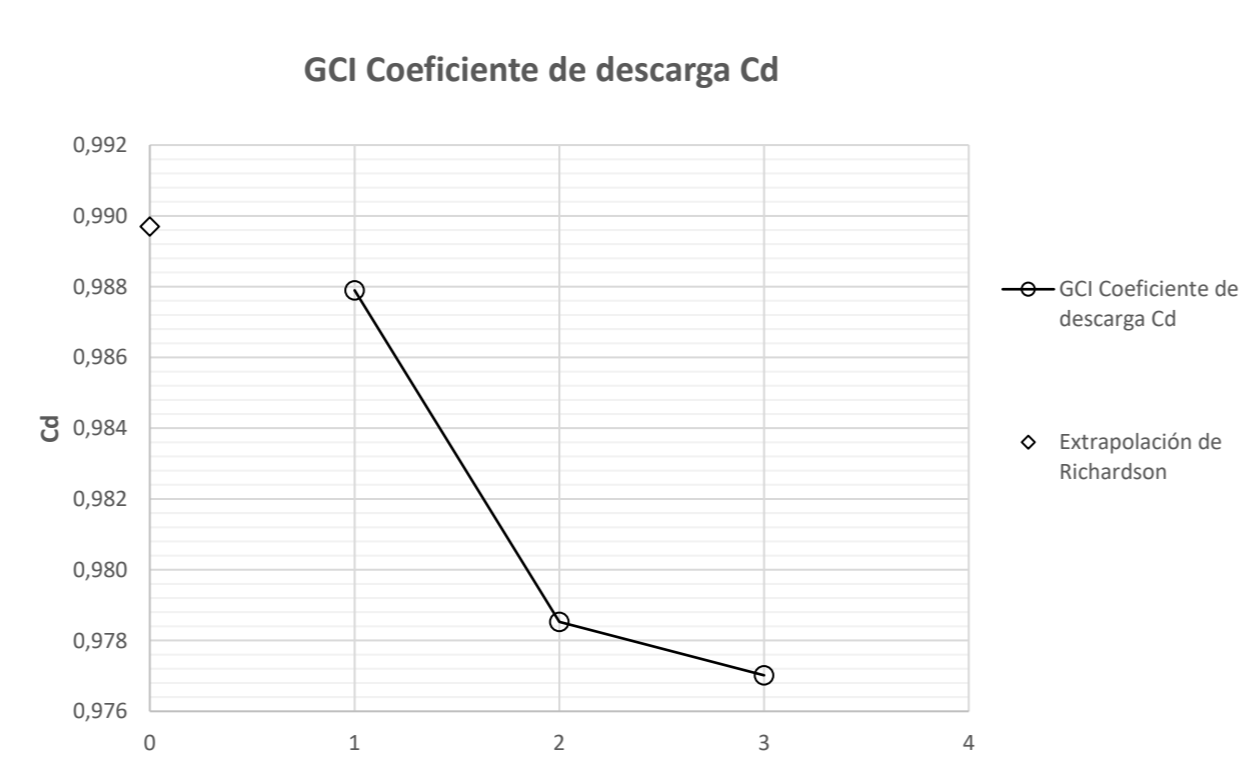
Fig.3-Tabla1 - Convergencia de malla para el coeficiente de descarga Cd usando el método del GCI.
